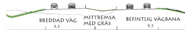
Sektion för E18 med skålad, bred mittremsa med gräs eller plantering som tar hand om dagvatten från vägbanan.
