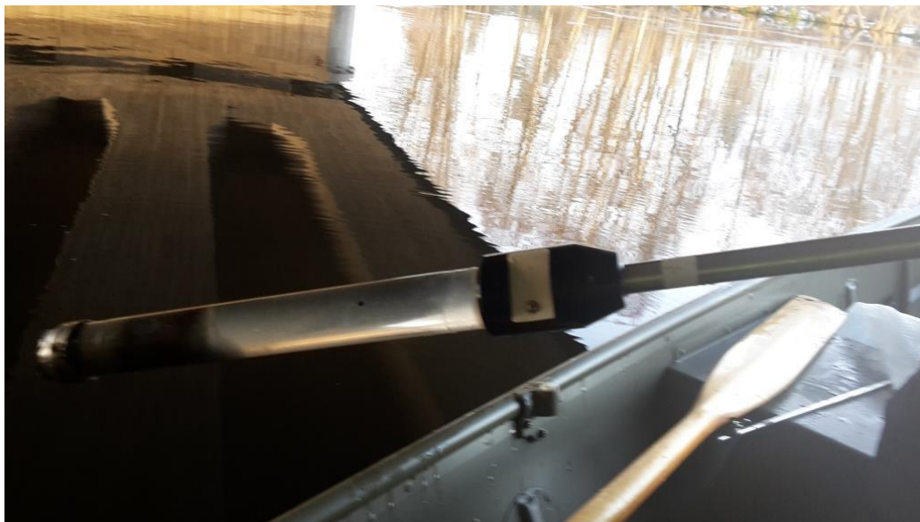
Figur 5.4. Provtagning vid provpunkt 15WS04. Rörprovtagare som användes vid sedimentprovtagningen.
