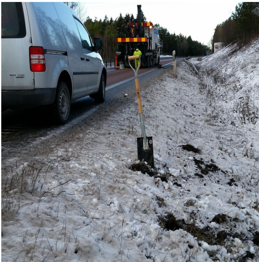
Figur 5.2. Handgrävning av provgrop vid provplats i dike och slänt
