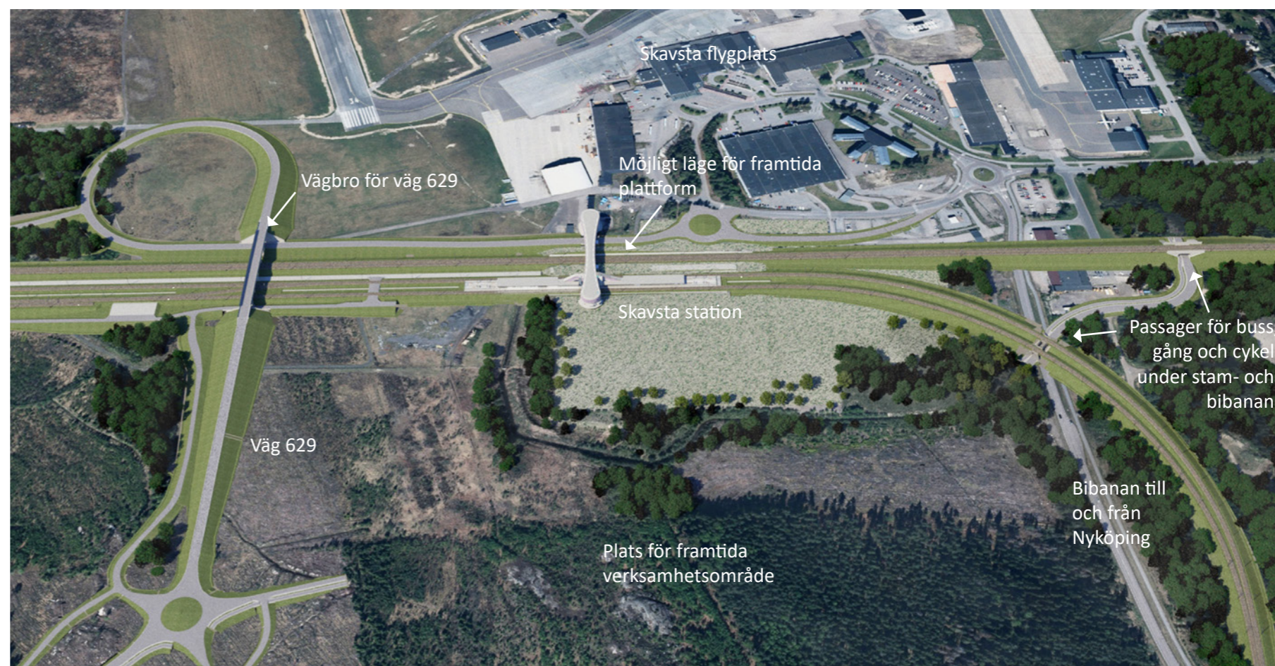
Figur 89. Översikt av området där Ostlänken passerar förbi Skavsta flygplats. Centralt i bild ligger Skavsta resecentrum med anslutning ner till mittplattform. Norr om anläggningen ligger Skavsta flygplats och i söder planeras ett nytt utvecklingsområde av Nyköpings kommun. Framtida planer är inte inkluderade i illustrationen, men anläggningen är anpassad efter dessa. I väst finns en vägpassage över anläggningen och i öst finns passager under den.
