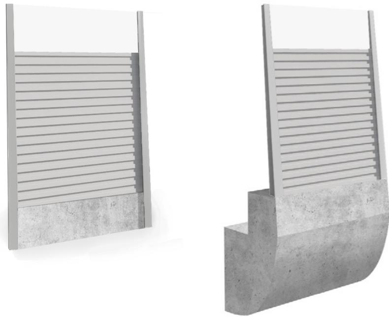
Figur 129. Princip för utformning av bullerskyddsskärm. Den perforerade plåten/sträckmetallen utförs i en matt grå kulör som motsvarar brons betongyta.
