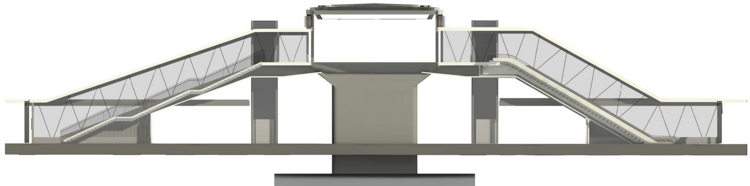
Figur 227. Tvärsektion bro och plattformanslutning.
