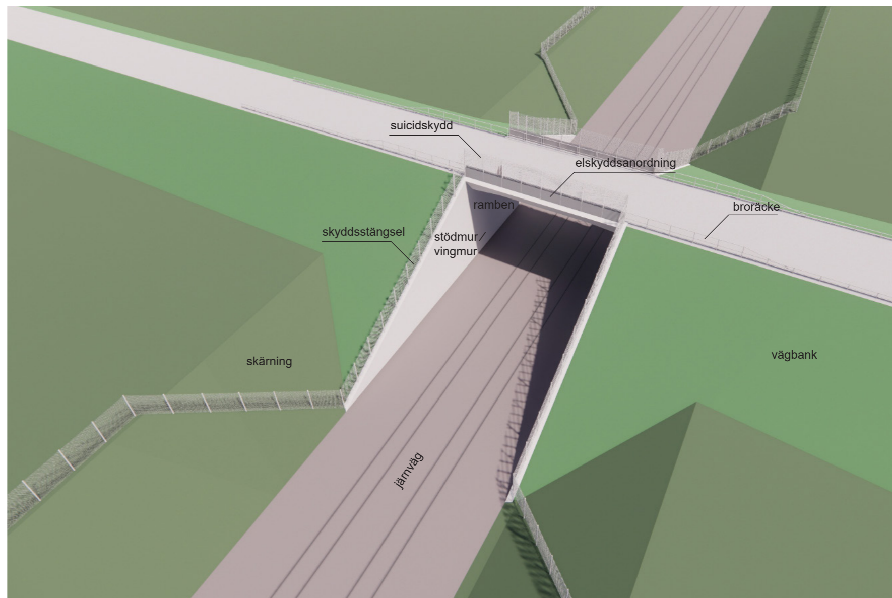
Figur 87. Illustration av vägbro plattrambrokonstruktion med raka vingmurar parallellt med järnvägen. Ståndare till suicidskydd enligt gestaltningssklass 2.
