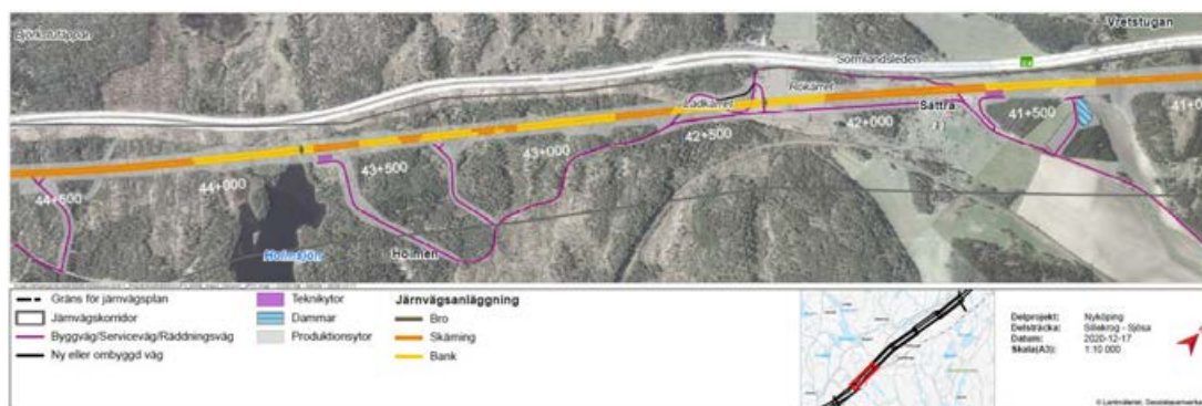
Figur 48. Placering av dammar, teknikytor och servicevägar från Vretstugan och förbi Holmsjön.
