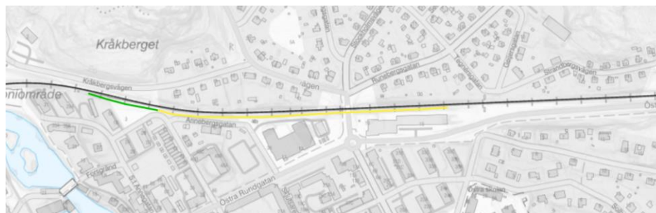
Figur 10. Grön linje visar där sikten blir fri med låga spårnära bullerskydd, dvs man ser över till Kråkberget från den södra sidan av järnvägen. Gul linje visar på en sträcka där konventionell bullerskyddsskärm anläggs på norra sidan om järnvägen, men eftersom denna ligger längre bort så minskas den visuella barriäreffekten ändå med en låga spårnära bullerskyddsskärm på den södra sidan.
