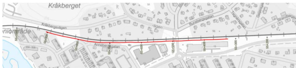
Figur 2. Föreslagen sträckning för låga spårnära bullerskydd.
