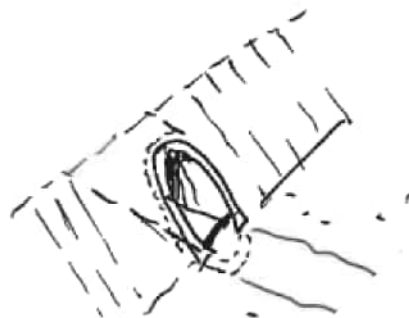
Bild 13.Principskiss för rörbroars avslutning mot vägbanks lutning.
