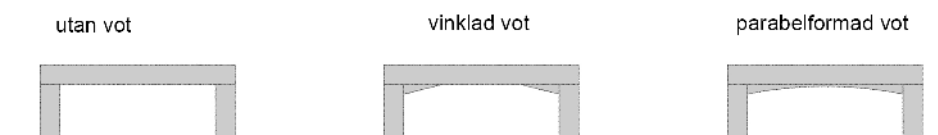
Bild 8. Principsektioner som illustrerar voter på bro.
