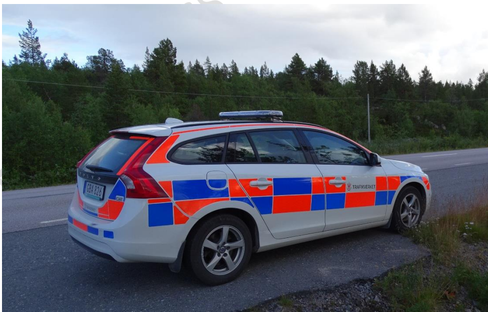
Figur 5.2 Utmärkning med battenburgmönster.
