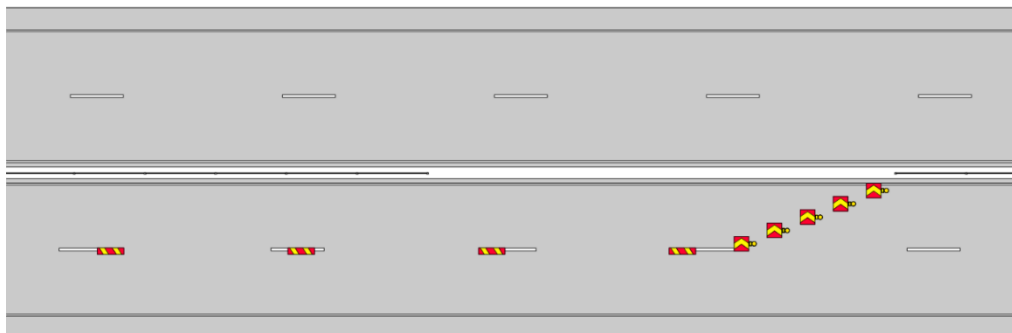
Figur 10.2. Utmärkning med X1 Markeringspil kompletterad med SIG 18 Gult blinkande ljus för påkallande av särskild försiktighet i funktion rinnande ljus när överledning går över ett körfält.
