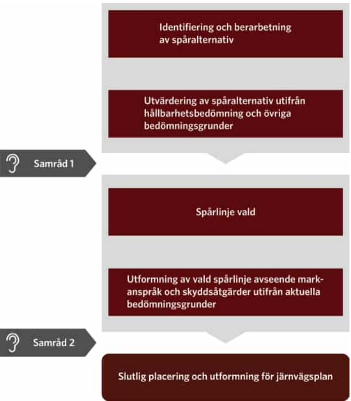
Figur 5.1: Metod för identifiering, utvärdering och val av placering samt utformning inom aktuell korridor.
