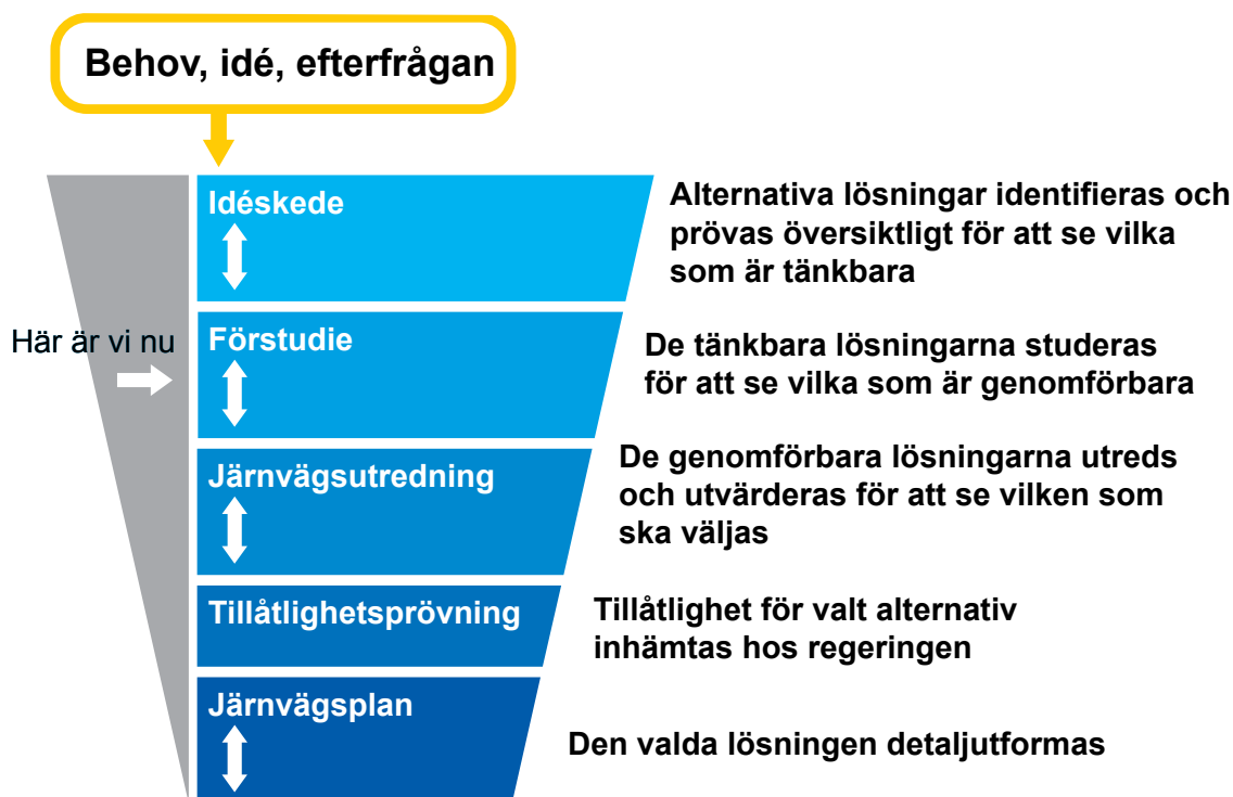
Figur 1.1: Planeringsprocessen för järnvägsprojekt
