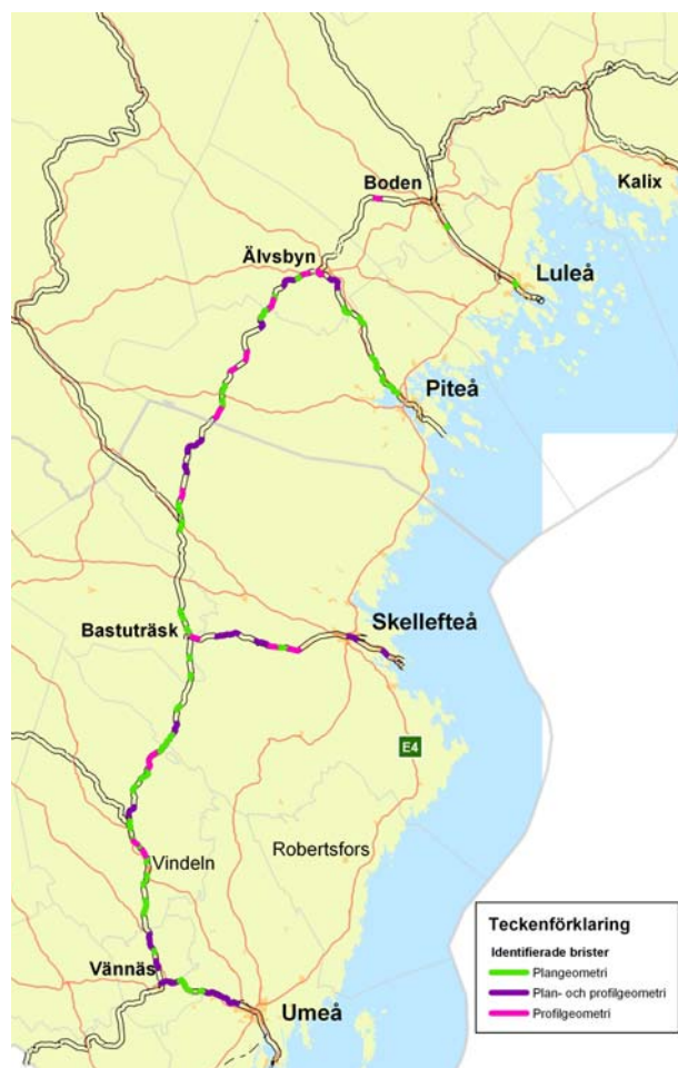
Figur 3.2: Identifierade brister på Stambanan Umeå-Luleå samt Skellefteåbanan och Piteåbanan med hänsyn till de krav som har ställts upp för Nollplusalternativet.
