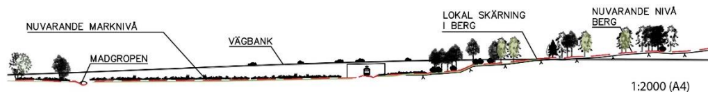
Figur 20. Vägbankens möte med Bohusbanan sedd från söder. Vägbanken släntas ned mot befintliga marknivåer, röd linje.
