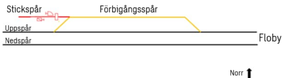
Figur 27. Schematisk bild av framtida förbigångsspår (gult) och stickspår (rött).
