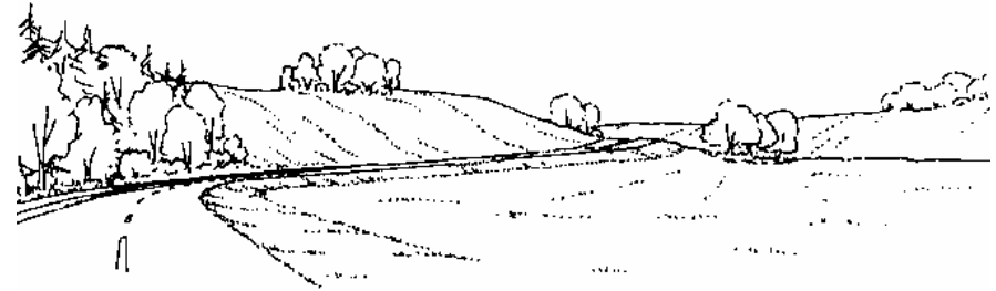
Figur 3.1 I ett storskaligt landskap anpassas linjeföringen efter landskapets storskaliga former. I ett småskaligt landskap kan linjeföringen behöva en mer lokal inpassning. Illustration hämtad från Văgar och gators utformning - VGU.
