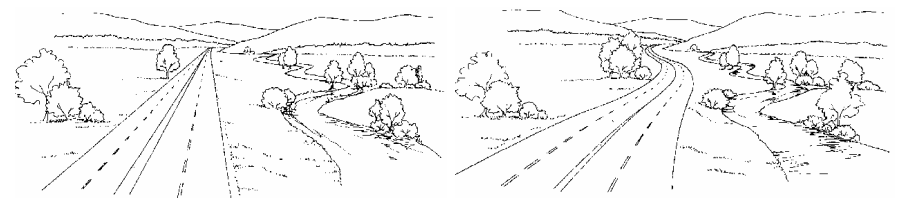
En väg som inte anpassas efter landskapets former upplevs monoton och svårare att läsa av för trafikanten. Genom en mjuk och rytmisk linjeföring kan vägen istället utformas för att smälta in och vägleda trafikanten genom landskapet. Illustration hämtad från Văgar och gators utformning - VGU.
