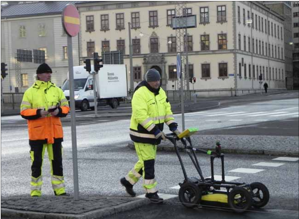
Figur 3. Radarantennen är monterad omedelbart ovanför markytan på en glidplatta. På kontroll- och dataupptecknings-enheten framför operatören visas vertikala profildata och viktiga mätparameter. För positionering av mätdata längst profil-linjen finns ett distanshjul monterat på ett av vagnens hjul. Systemet körs längs med 50 meter långa parallella profilsnören över undersökningsområdet. Foto: Linda Andersson.
