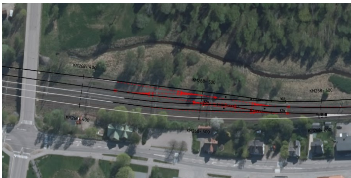
Figur 11 Röda linjer visar spår och växlar som tas bort eller flyttas. Svarta linjer är nya eller flyttade spår och växlar. Grått visar det som inte påverkas.
