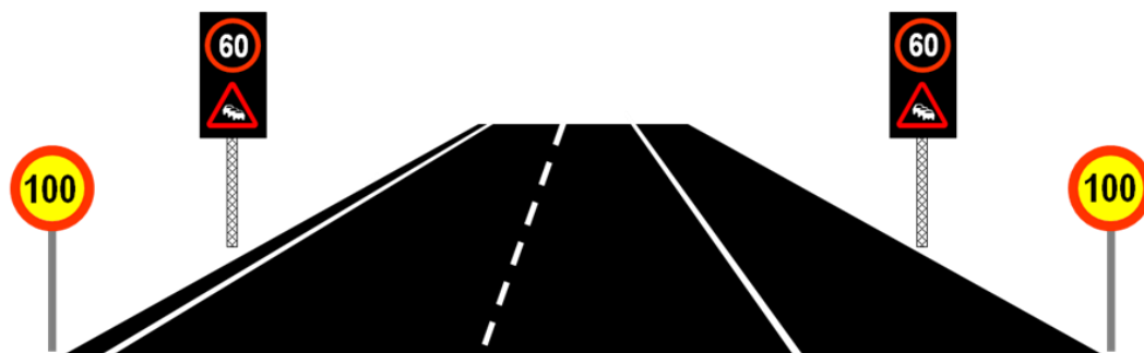
Figur 6.10 Dynamisk varning och sänkt variabel hastighetsgräns på motorväg utan portal och med hastighetsgräns 80 km/h eller högre
