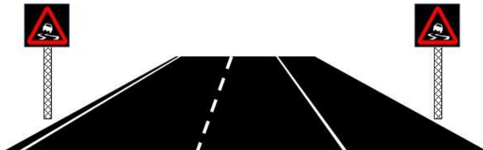
Figur 6.7 På motorväg med normal hastighetsgräns 70 km/h eller lägre är det tillräckligt med varningsmärke för att varna för fara.
