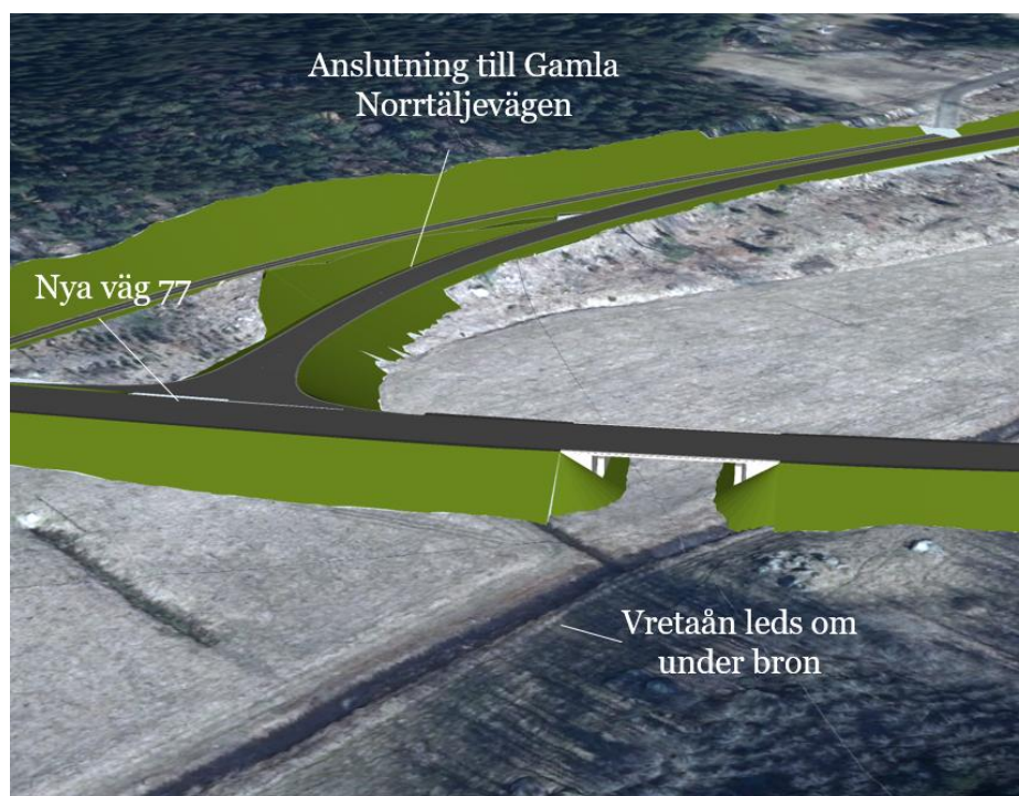
Figur 31. Utsnitt från projektets samordningsmodell på bro 445. Vy mot norr. I förslaget grävs Vretaån om för anpassning till broöppningen.
