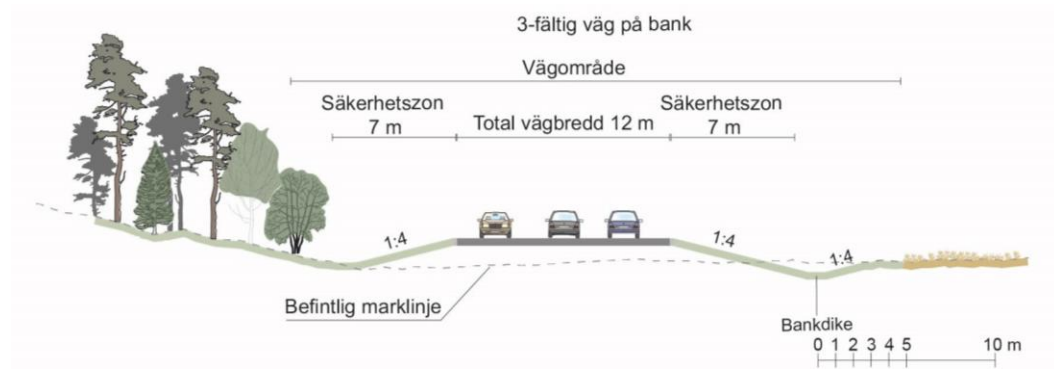
Figur 5. Typsektion 3-fältig väg på bank, slänt 1:4. Vänstra delen av figuren visar sektion i skogsmark och den högra delen visar odlingslandskapet.
