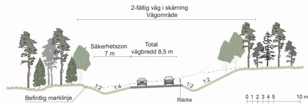
Figur 7. Typsektion 2-fältig väg i skärning som visar två olika aktuella utformningsalternativ. Vänstra delen av figuren visar sektion med flackare slänt och en bredare säkerhetszon och den högra delen visar en brantare slänt men med vägräcke.
