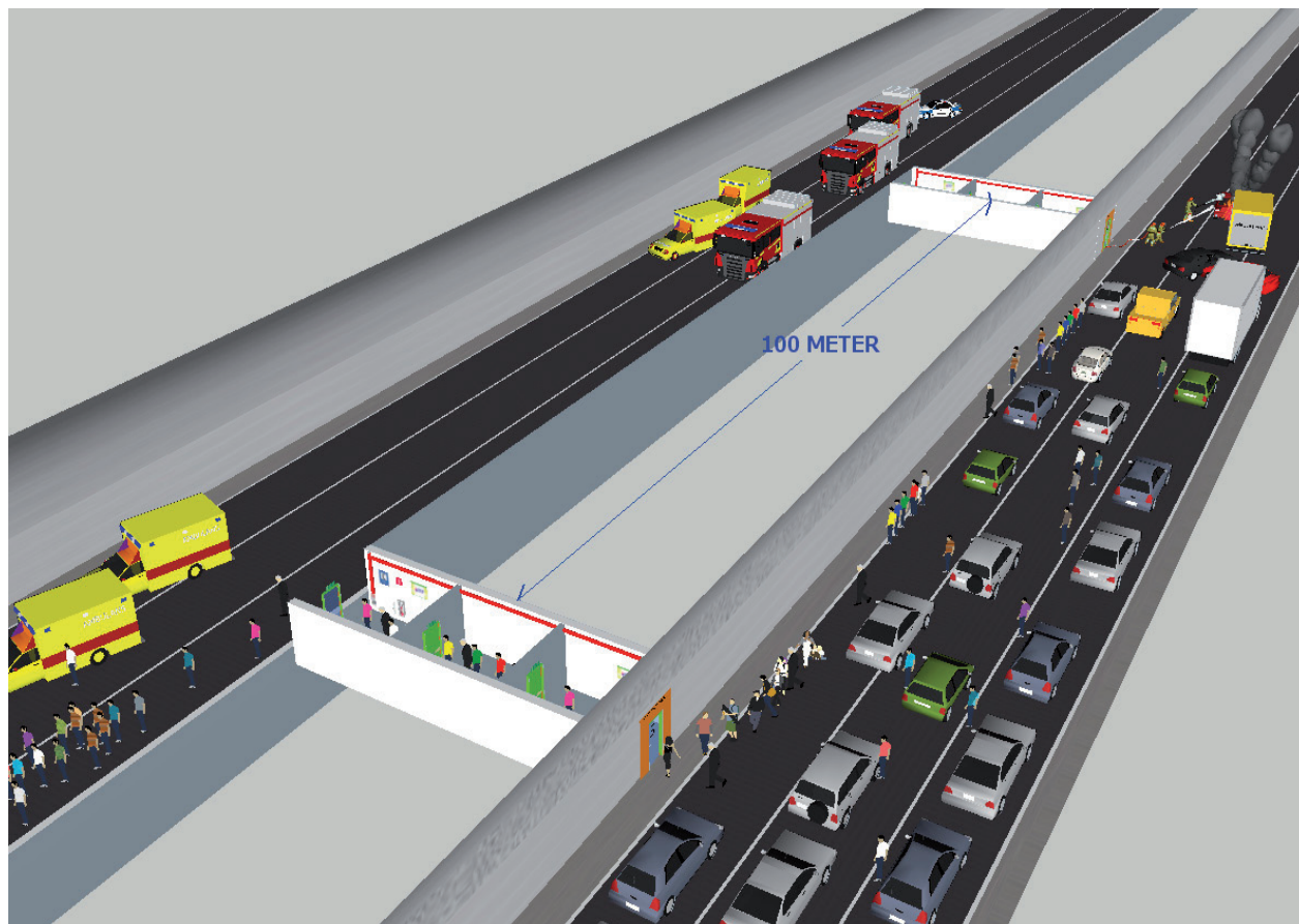
Figur 41 De två tunnelrören kommer att förbindas av utrymningsvägar så att man vid en olycka kan ta sig över till det andra tunnelröret. Båda tunnelrören stängs av för inkommande trafik vid en olycka.
