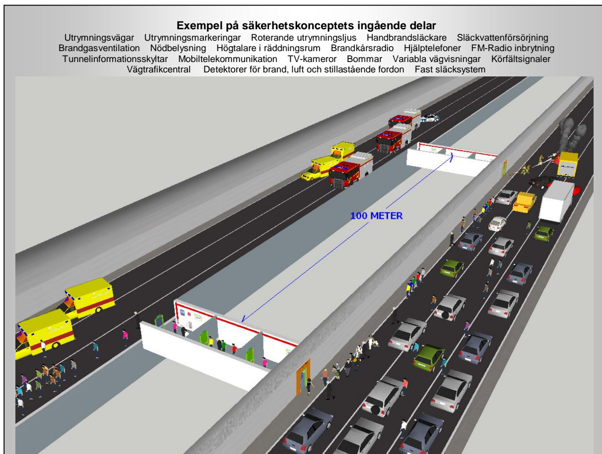
Figur 1 Säkerheten i sammanfattning. De i bilden angivna funktionerna och de säkerhetstekniska installationerna i övrigt avser delar av funktioner i säkerhetskonceptet för tunneln.
