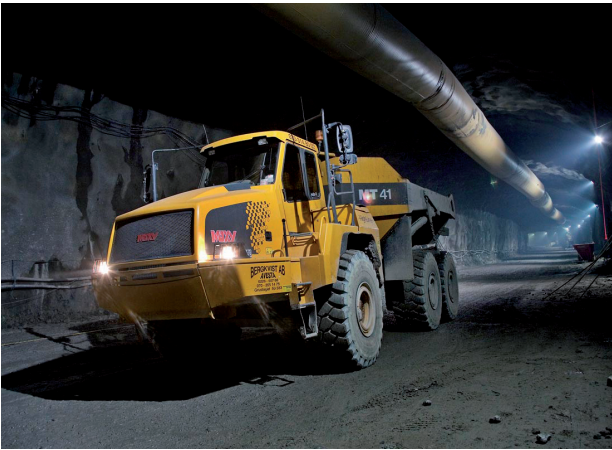
Figur 52 Masstransport vid tunneldrivning.
