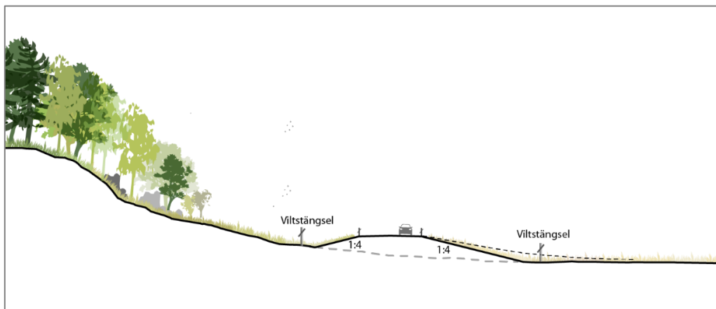
Figur 57. Principiell tvärsektion för låg bank (1:4) visar hur vägen tar stöd i kantzoner av knallar och kuperade höjder.
