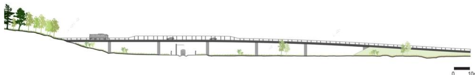
Figur 7. Schematiskt exempel som visar en landskapsbro med passage över järnväg.
