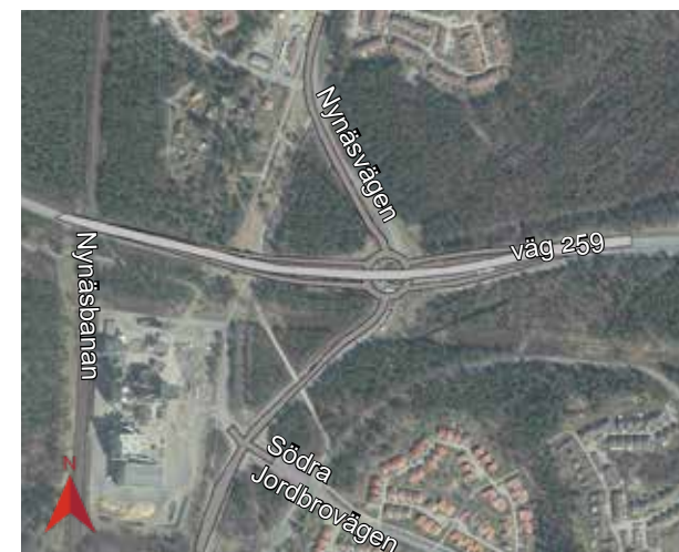
Figur 3.86 Alternativ utformning för trafikplats Slätmosse med cirkulationsplats och lokalväg under väg 259.
