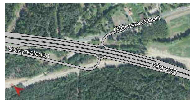
Figur 3.55 Alternativ utformning med cirkulationsplats under väg 259.
