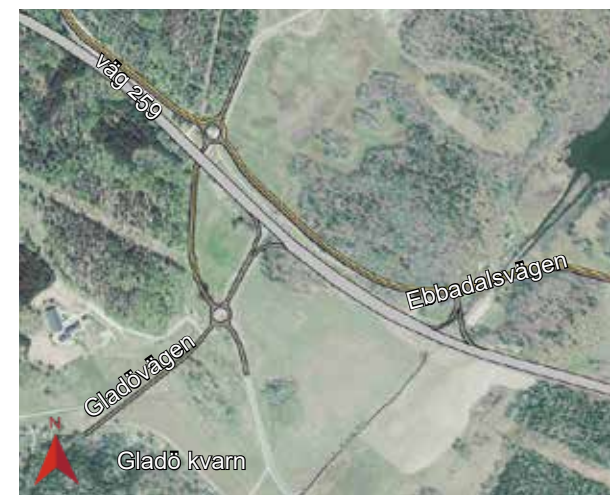
Figur 3.74 Alternativ placering med trafikplats väster om valt alternativ (G6) med utdragna klöverramper som ansluter till Gladövägen och Ebbadalsvägen via två cirkulationsplatser.
