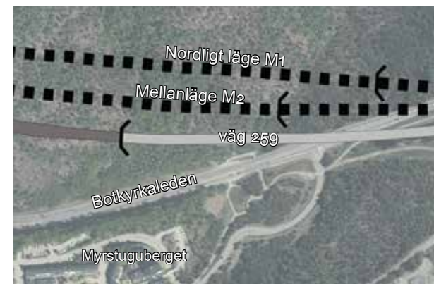
Figur 3.51 Alternativa lägen för Masmotunnelns södra tunnelmyrning (streckad svart linje).
