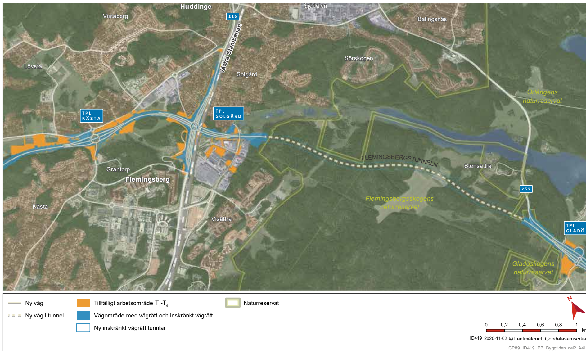
Figur 3.45 Anläggningar under byggskedet, sträckan Glömsta-Gladö kvarn.
