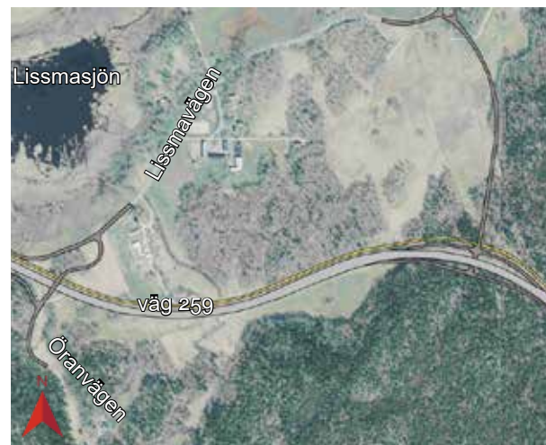
Figur 3.77 Alternativ placering för trafikplats Lissma med trafikplats i bergsterrängen öster om valt alternativ (L1).
