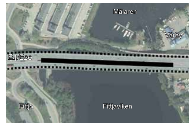
Figur 3.49 Alternativ utformning för Vårbybron med vägren som nytt körfält (streckad svart linje) samt hoppgjutning (heldragen svart linje).
