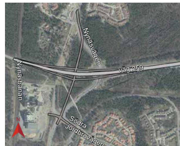
Figur 3.87 Alternativ utformning för trafikplats Slätmosse med lokalväg och fyrvägs korsningar under väg 259.
