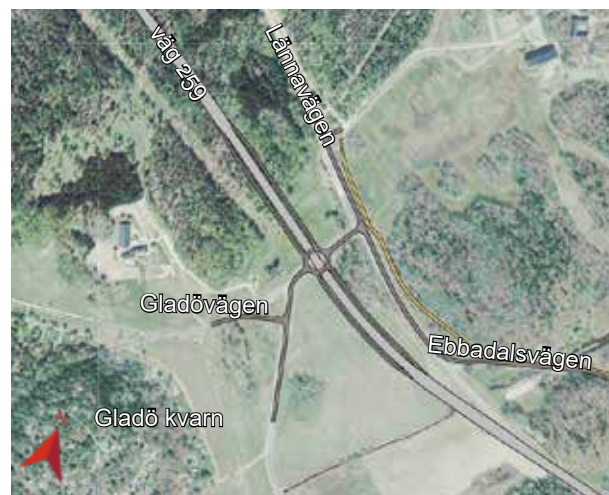
Figur 3.72 Alternativ placering med trafikplats vid Gladövägen söder om Lännavägen (G4) med ruterramper, cirkulationsplats över väg 259 och koppling till sydligt läge för Flemingsbergstunnels mynning (F4).
