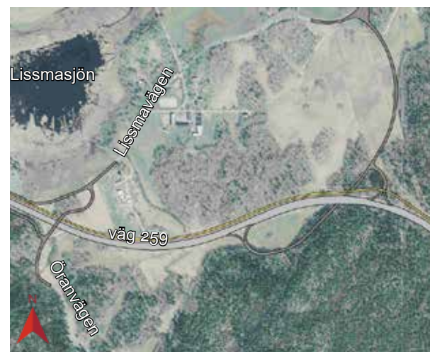
Figur 3.76 Alternativ placering för trafikplats Lissma med utdragen trafikplats i kanten på odlingslandskapet öster om valt alternativ (L1).
