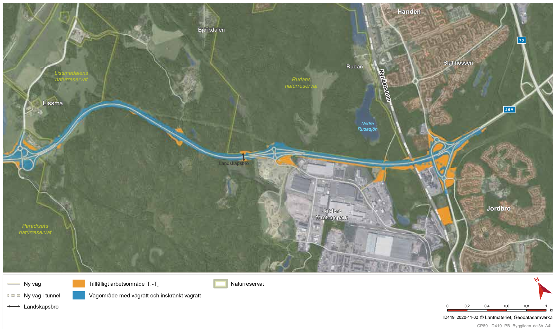
Figur 3.47 Anläggningar under byggskedet, sträckan Lissma-Jordbro.
