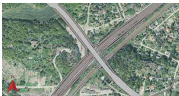
Figur 3.63 Alternativ utformning med trafikplats i tre plan med cirkulationsplats underst, väg 226 i mitten och väg 259 överst.
