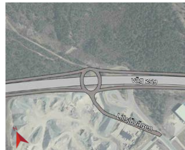
Figur 3.85 Alternativ utformning för trafikplats Rudan med cirkulationsplats över väg 259 och ruterramper.
