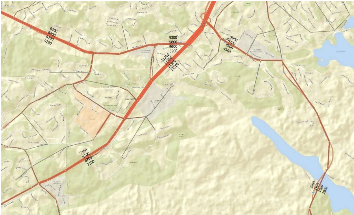
Figur 7- Jämförelse mellan uppmätta flöden (yttre) och modellgenererade flöden (inre) – ÅMD 2014 personbilar.
