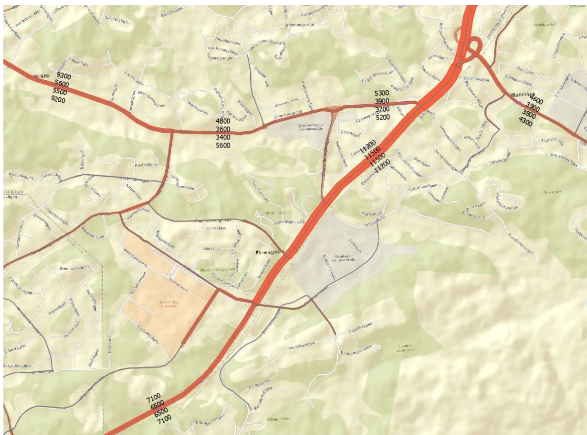
Figur 1- Jämförelse mellan uppmätta flöden (ytterst) och modellgenererade flöden (innerst) – AMD 2014 personbilar
