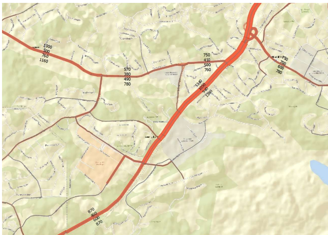
Figur 3- Jämförelse mellan uppmätta flöden (yttre) och modellgenererade flöden (innerst) – AMD 2014 lastbilar
