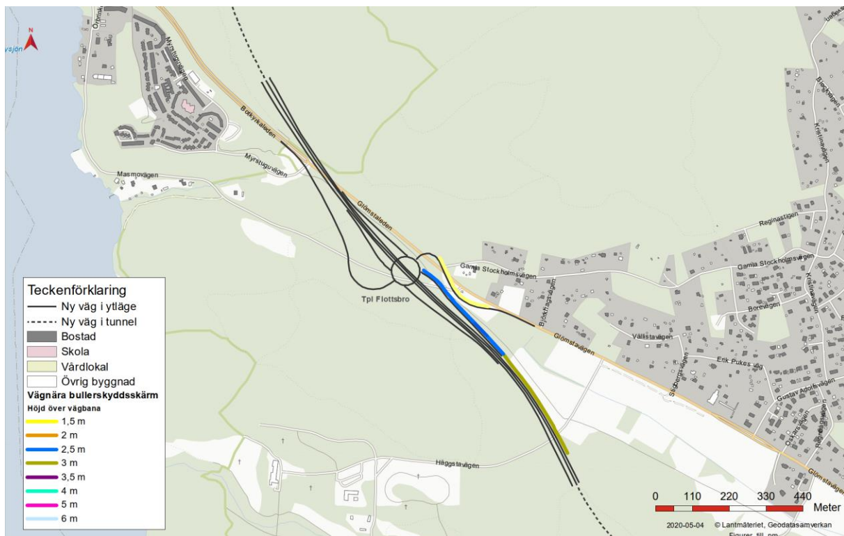
Figur 10. Vägnära bullerskyddsåtgärder i delområde 2 Flottsbro.
