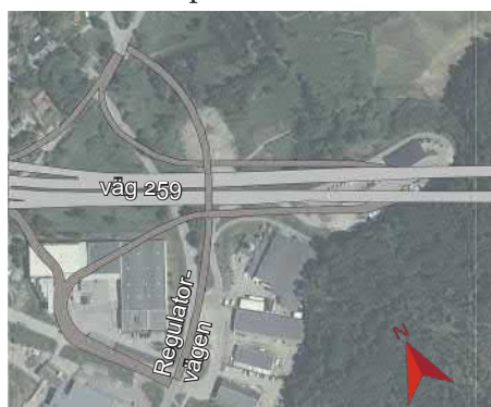
Figur 3.37 Trafikplats med klöverramper vid Regulatorvägen.
