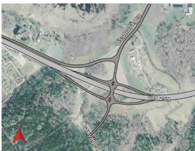
Figur 3.61 Trafikplats Lissma med ruterramper och dubbeldroppe.
