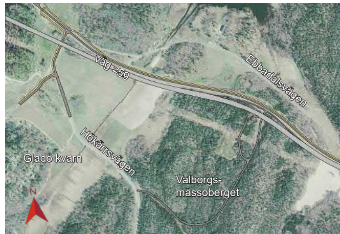
Figur 3.52 Trafikplats Gladö med kombinerad klöver- och ruterramper. Separat planskild koppling med lokalvägarna.
