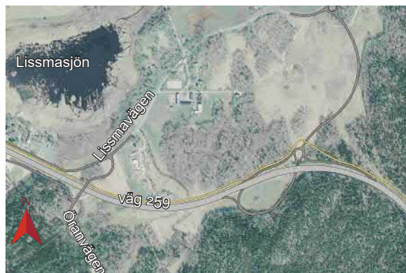
Figur 3.64 Trafikplats Lissma, klöverramp inpassat utmed brynzonen söder om väg 259, (11).
