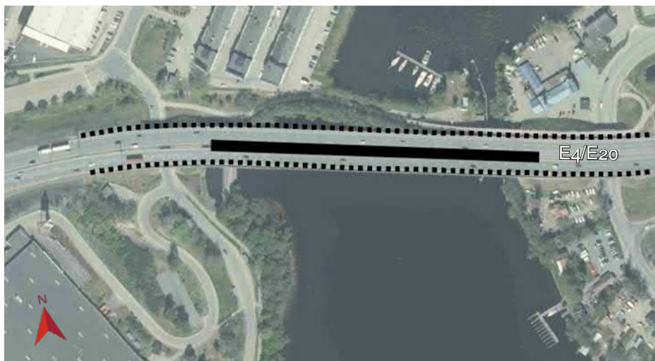
Figur 3.5 Variant att bygga ut befintliga brokonstruktioner med en längsgående fog eller ihopgjutning illustreras med svart heldragen linje. Variant att använda vägrenen som körfält illustreras med streckad svart linje.
