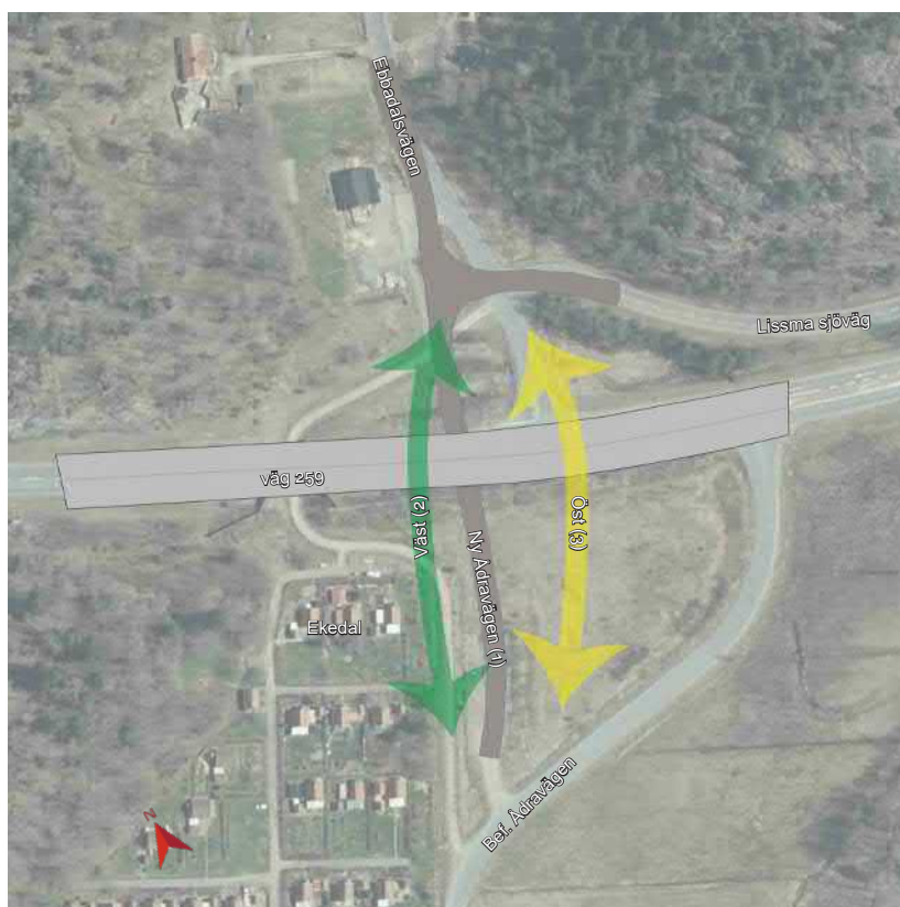
Figur 3.54 Alternativ för ny dragning av Ådravägen planskilt med väg 259. Vald sträckning redovisas med grå färg på kartan.
