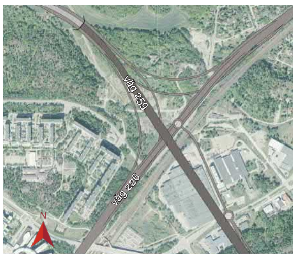
Figur 3.29 Trafikplats Solgård med västligt läge för tunnelmynning likt de båda alternativen ovan.
