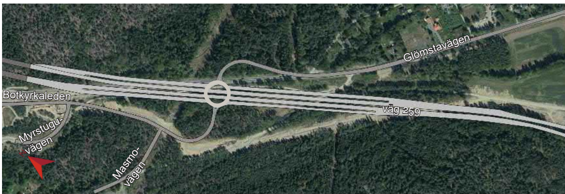
Figur 3.12 Ruterramper som ansluter till överliggande cirkulation, placerad i ett västligt läge i anslutning till Botkyrkaleden och Glömstavägen.
