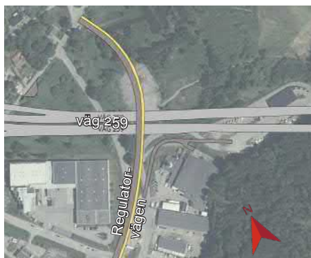
Figur 3.38 Alternativ med Regulatorvägen på bro över väg 259.
