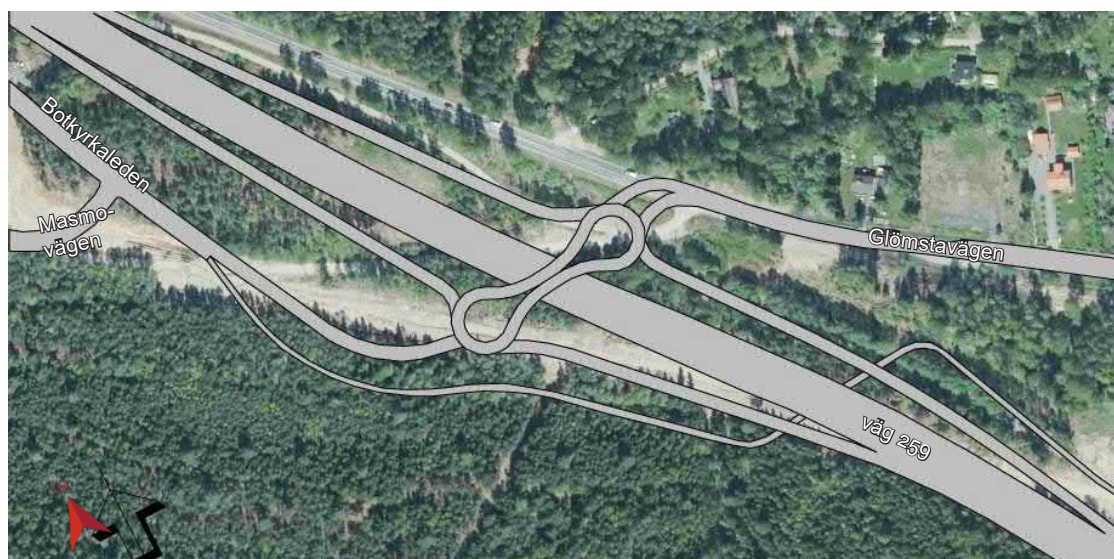
Figur 3.17 Ruterramper som ansluts till kompakt dubbeldroppe över väg 259, östlig variant.
