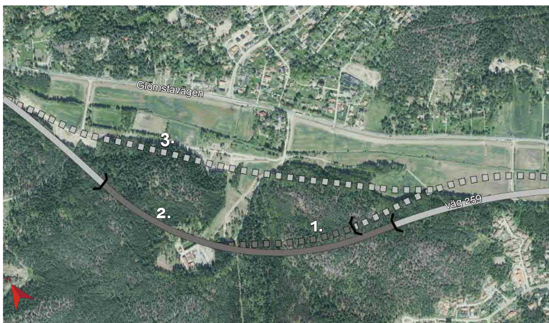
Figur 3.20 Studerade sträckningar av Glömstatunneln, valt alternativ visas med mörkgrå linje (2), avfört tunnelalternativ mörkgrå streckad linje(1). Ljusgrå streckad linje visar på alternativ med väg på bank (3).
