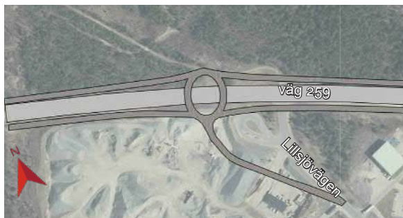
Figur 3.71 Trafikplats Rudan, ruterramper med cirkulation.
