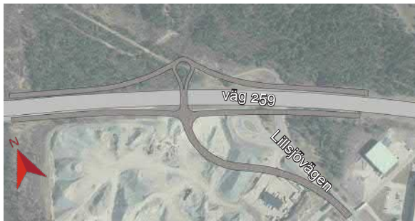
Figur 3.70 Trafikplats Rudan, ruterramper och enkeldroppe.
