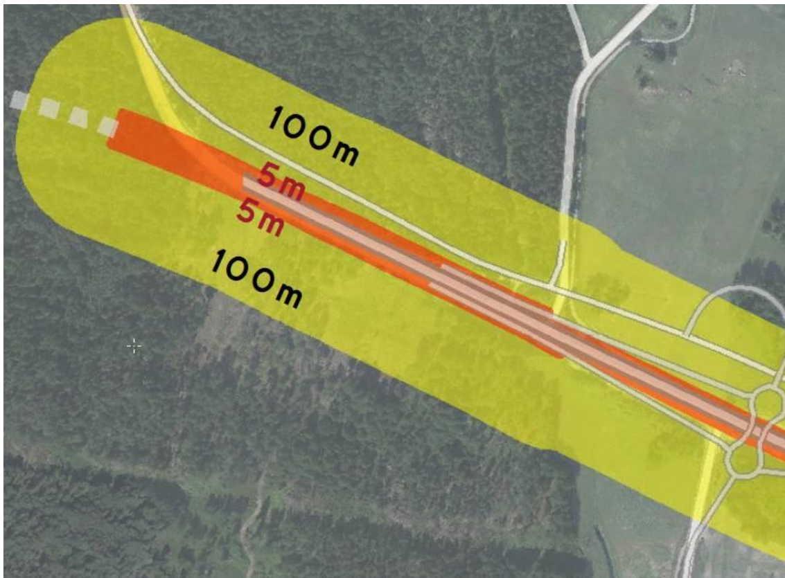
Figur 72. Vägvansnitt 7, buffertzon TS med åtgärder
