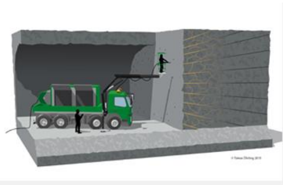
Figur 7 En blandning av cement och vatten pressas under högt tryck in i borrhålen och vidare ut i bergets sprickor. Cementen härdar och tätar på det viset berget runt tunneln.
