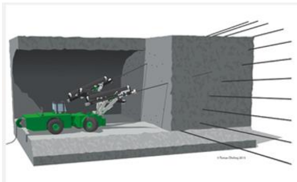
Figur 6 I en krans runt tunneln borrar cirka 20–25 långa hål snett framåt i berget.
