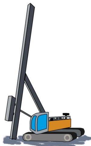
Figur 5 Spontmaskin eller pålkran
