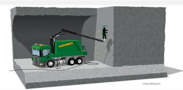
Figur 9 Hålen laddas sedan med sprängmedel. Mängden anpassas efter omgivningarnas känslighet.
