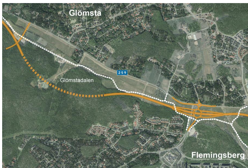
Figur 3 Glömstatunnelns linjeföring, väg i tunnel markerad med streckad gul linje. Vit streckad linje är gång- och cykelväg.
