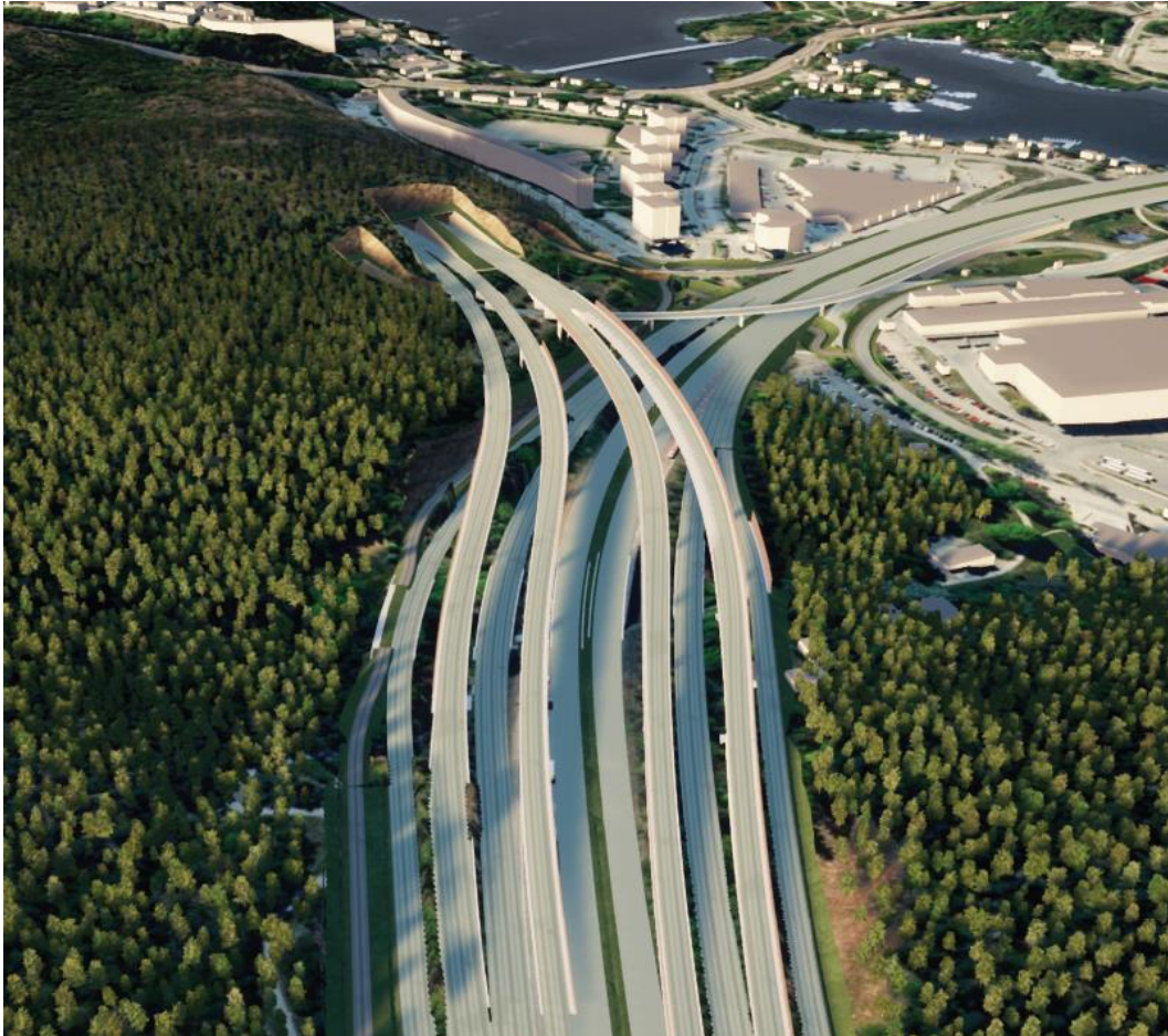
Figur 22. Illustration av Tvärförbindelsens ramper vid anslutningen till E4/E20 vid trafikplats Gömmaren.
