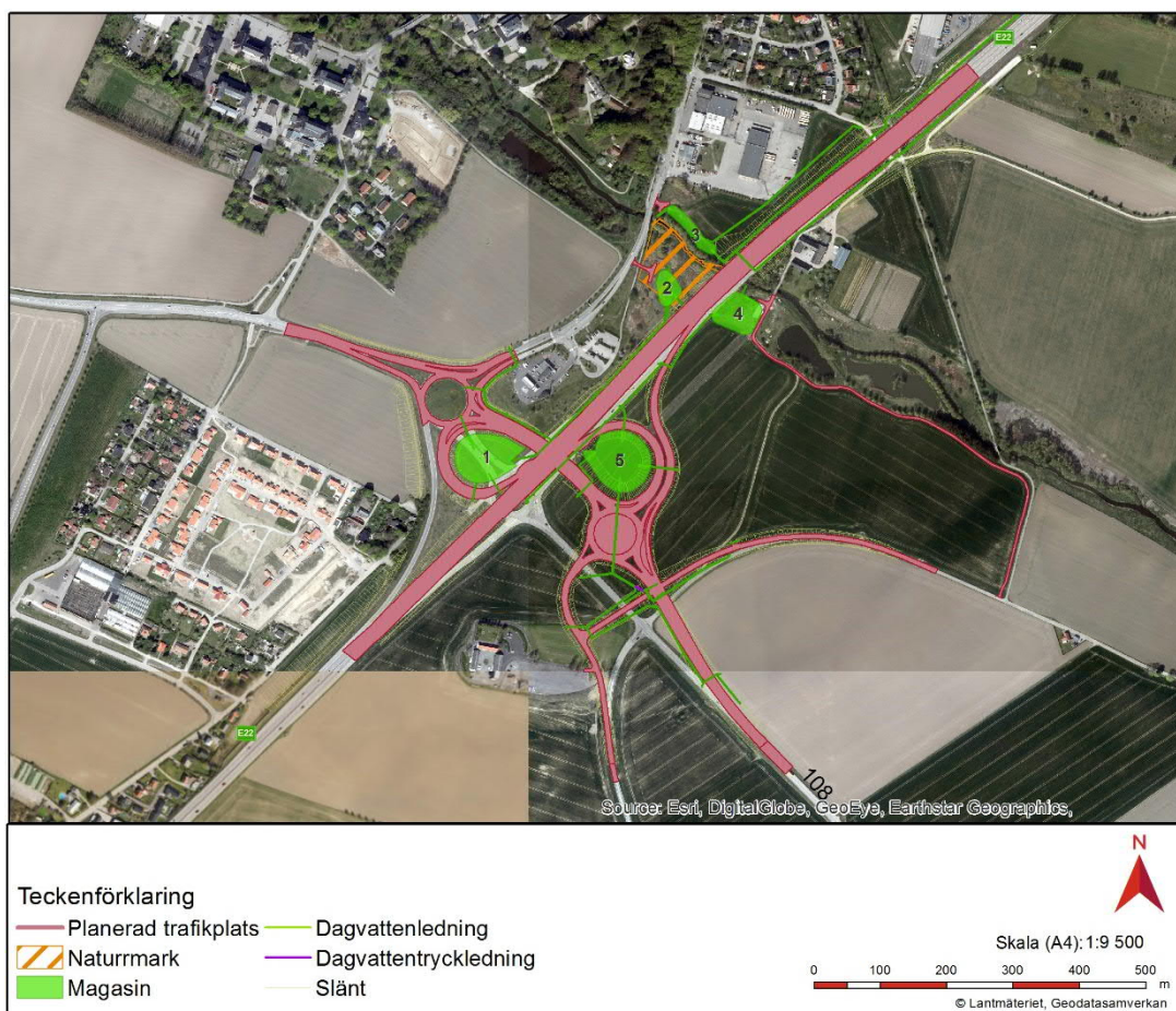
Figur 24 - Schematisk dagvattenhantering för trafikplats Lund Södra med 5 dagvattendammar
