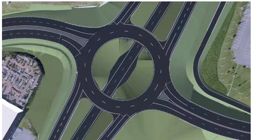
Bild 20. Driftfickor är planerade utmed väg 26 i cirkulationen för att underlätta skötsel och underhåll.
