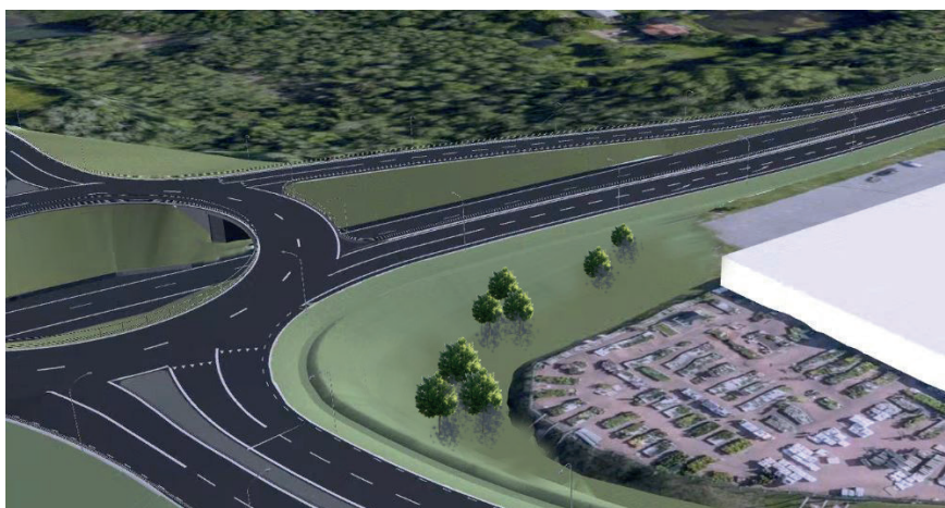
Bild 10. Ytan som uppstår där befintlig gång- och cykelväg tas bort fylls ut och terrängmodelleras för att ge en harmonisk anslutning mot intilliggande fastighet (Plantagen).
