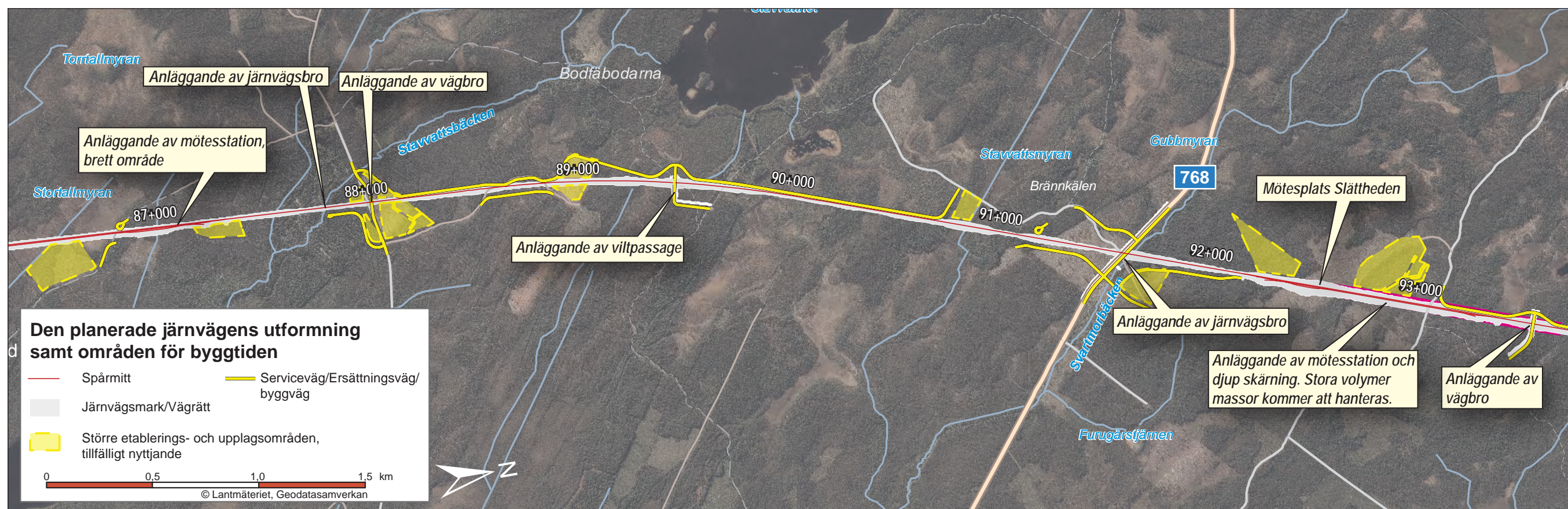
Figur 4.2:15 Den planerade järnvägens utformning samt större arbets- och upplagsområden under byggtiden, karta 2 (4).
