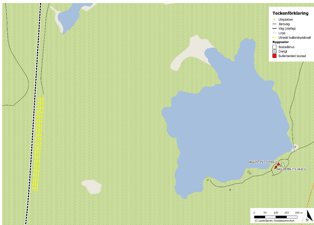
Figur 6.1: Bullerberört område i Daglöstens med utredd bullerskyddsåtgärd (vall).
