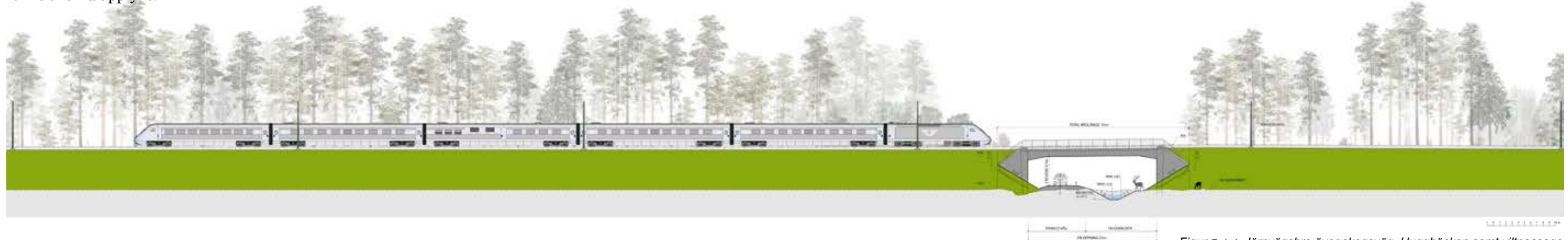
Figur 5.4.4. Järnvägsbro över skogsväg, Huggbäcken samt viltpassage
