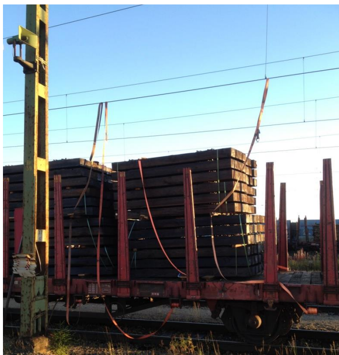
Bild 14. Lösa spännband som riskerar skada kontaktledningen.
