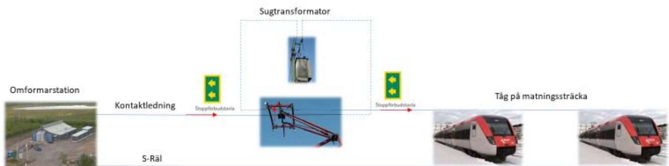
Bild 3. Visar strömmens väg från omformarstationen till fordon på linjen vars strömavtagare överbryggar i en stoppförbudszon.
