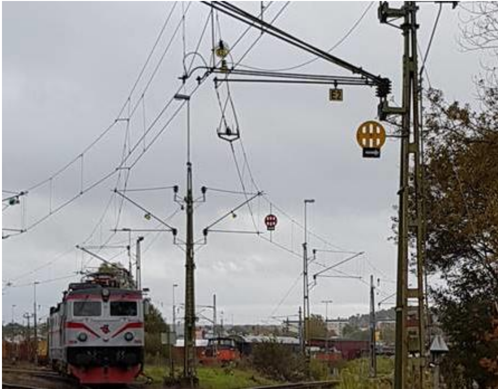
Bild 10. Gul elspärrsignal med tilläggskyll med pil. Kontrollera att spåret bortom elspärrsignalen är spänningssatt innan passage.
