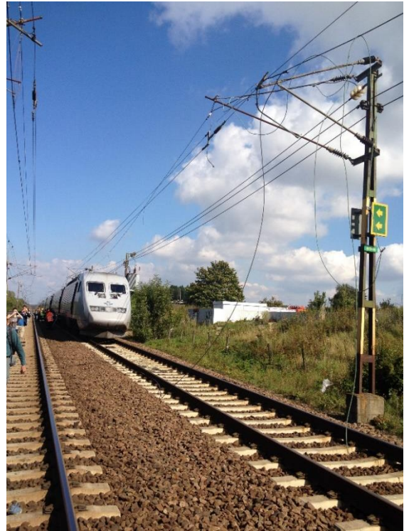
Bild 18. Nedriven kontaktledning i stoppförbudszon
