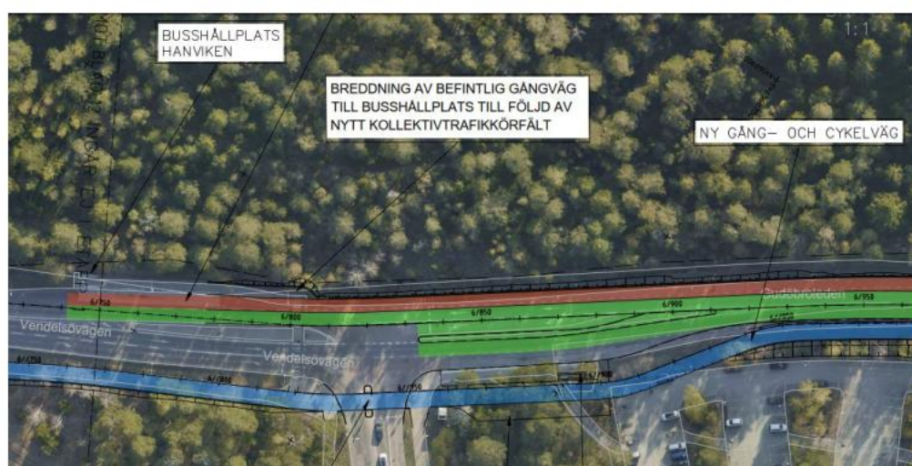
Figur 5:2 Utklipp ur illustrationsritning 13 (306T0213). Föreslagen utformning vid Skrubba Malmväg, vid cirka km 6/800
