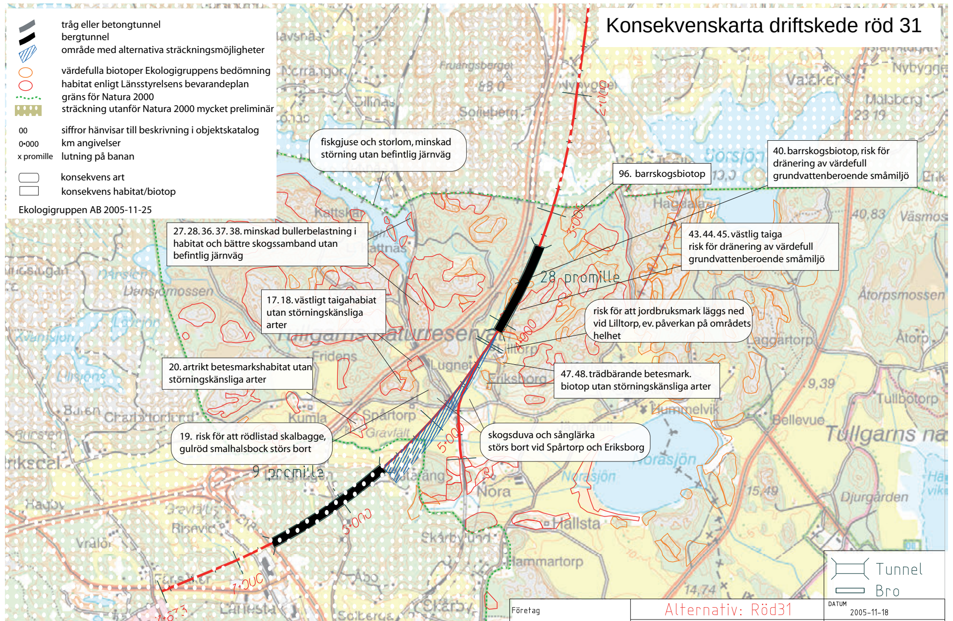
Figur 29 Alternativ Röd 31. Sträckning och läge för tunnlar. Svart är bergtunnel, grått är tunnel som antingen är tråg eller betongtunnel som byggs i schakt. Konsekvenser anges i textrutor.
