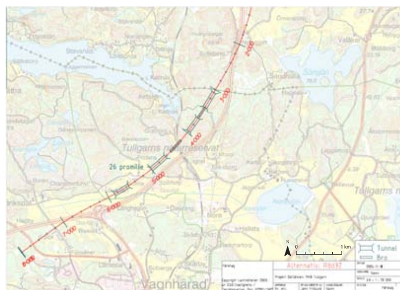
Figur 3.2 Alternativ Röd 32 var ett försök att undersöka en sträckning helt väster om motorvägen. Alternativet påverkade flera Natura 2000 naturtyper på ömse sidor befintlig järnväg och vid Kumla gård och har därför förkastats.
