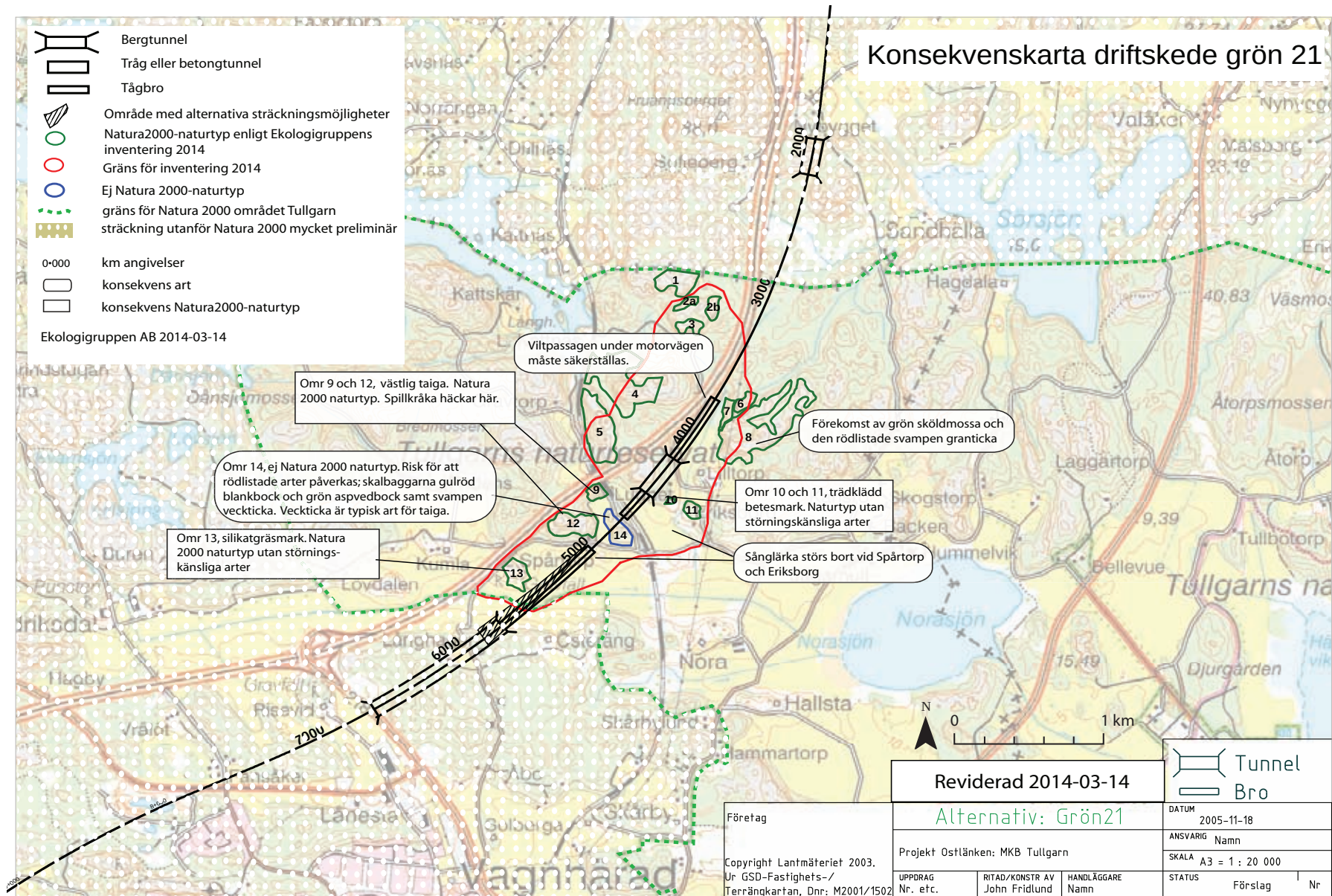
Figur 7.4 Alternativ Grön 21. Sträckning och läge för tunnlar. Konsekvenser anges i textrutorna. Observera att den streckade korridoren endast anger område inom vilken järnvägen kan förläggas. Bredden på den färdiga järnvägen är som regel 15 meter (bredare då den går i slänt eller på bank).
