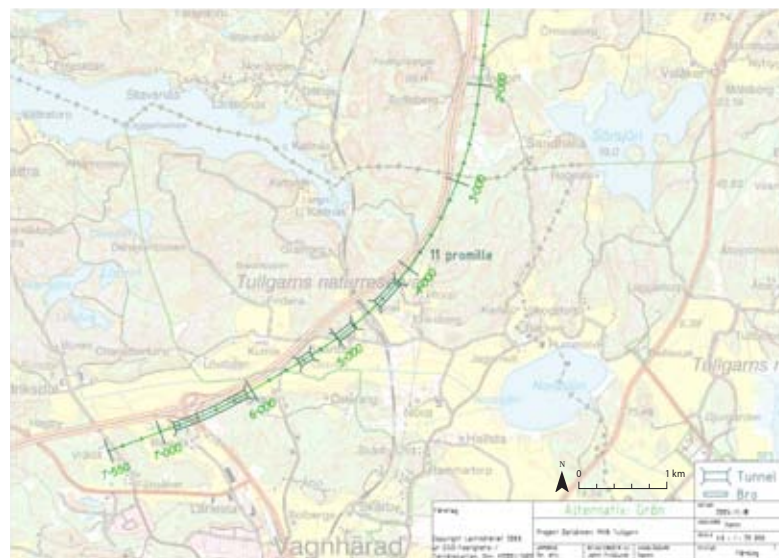
Figur 3.1 Alternativ Grön är ursprungsförslaget till Grön 21. Grundalternativet Grön låg mycket nära motorvägen men påverkade ett område med Natura 2000 naturtyp vid km angivelsen 3200 och har därför förkastats.
