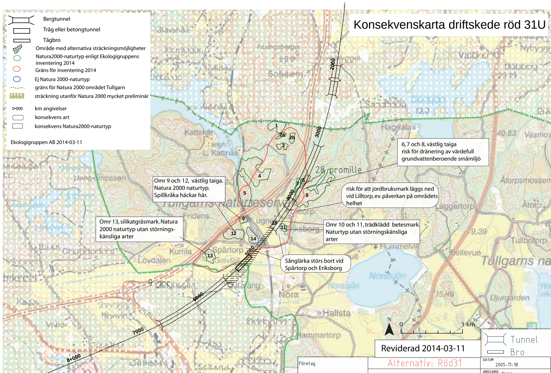
Figur 7.19 Alternativ Röd 31U. Sträckning och läge för tunnlar, tråg och järnvägsbroar. Tråget är schematisk och påverkar inte utbredningen av Natura 2000 naturtyper. Konsekvenser anges i textrutor.
