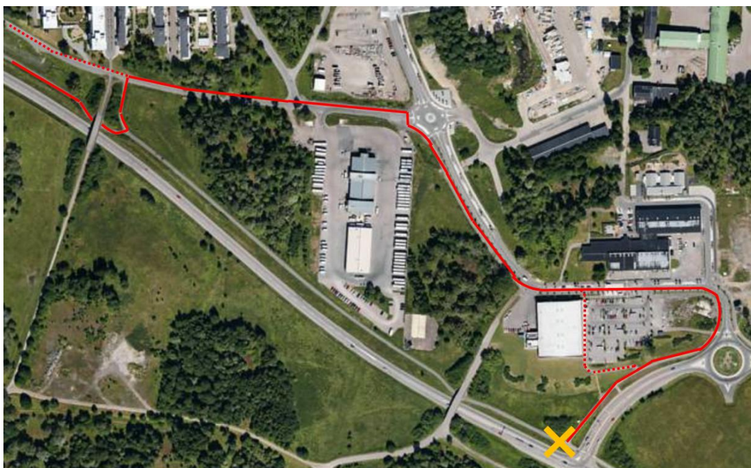
Figur 12. Omledning av cykeltrafik då cykelvägen är avstängd (gula krysset) på grund av vägarbete. Den heldragna röda linjen visar den väg cyklisterna hänvisas till medan de prickade linjerna visar den väg de egentligen väljer. Källa: www.eniro.se
