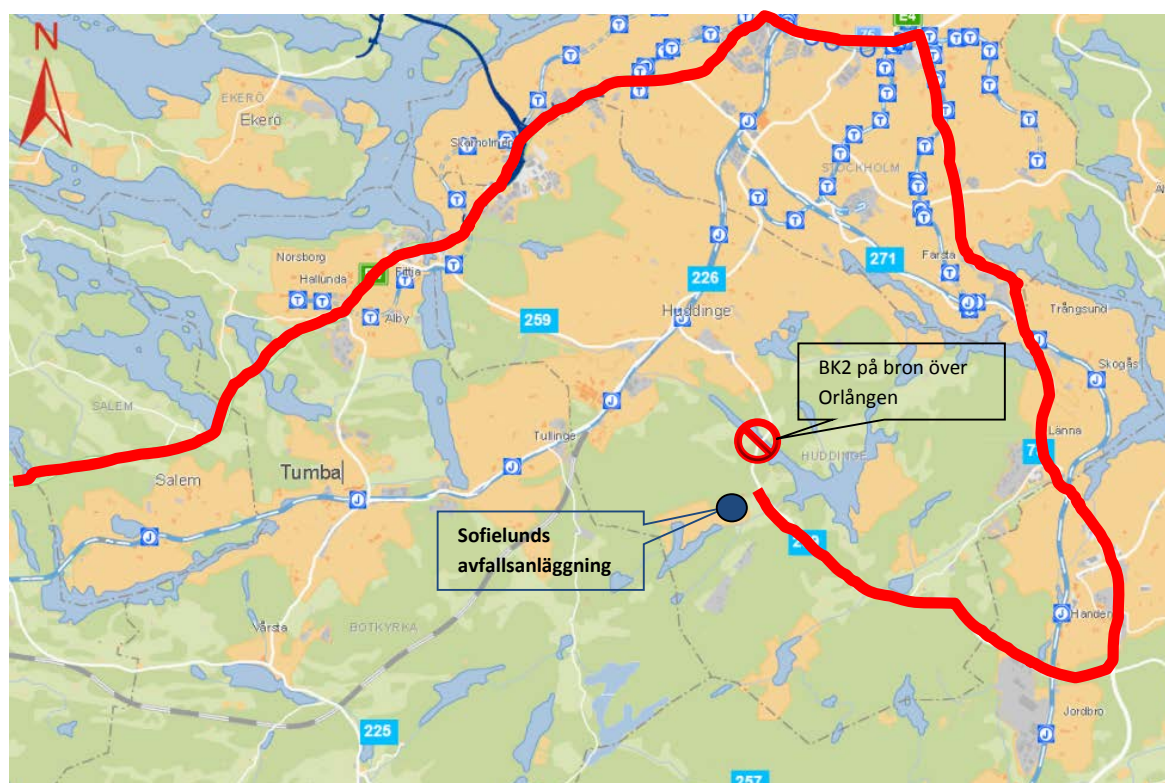
Figur 3.17. Exempel på situation i dagens trafiknät. Den nedsatta bärigheten på bron över Örlången (väg 259) gör att tunga avfallstransporter till och från Sofielunds avfallsanläggning i Gladö industriområde måste köra en omväg via väg 73 och Södra Länken för vidare färd söderut på E4/E20 61 .
