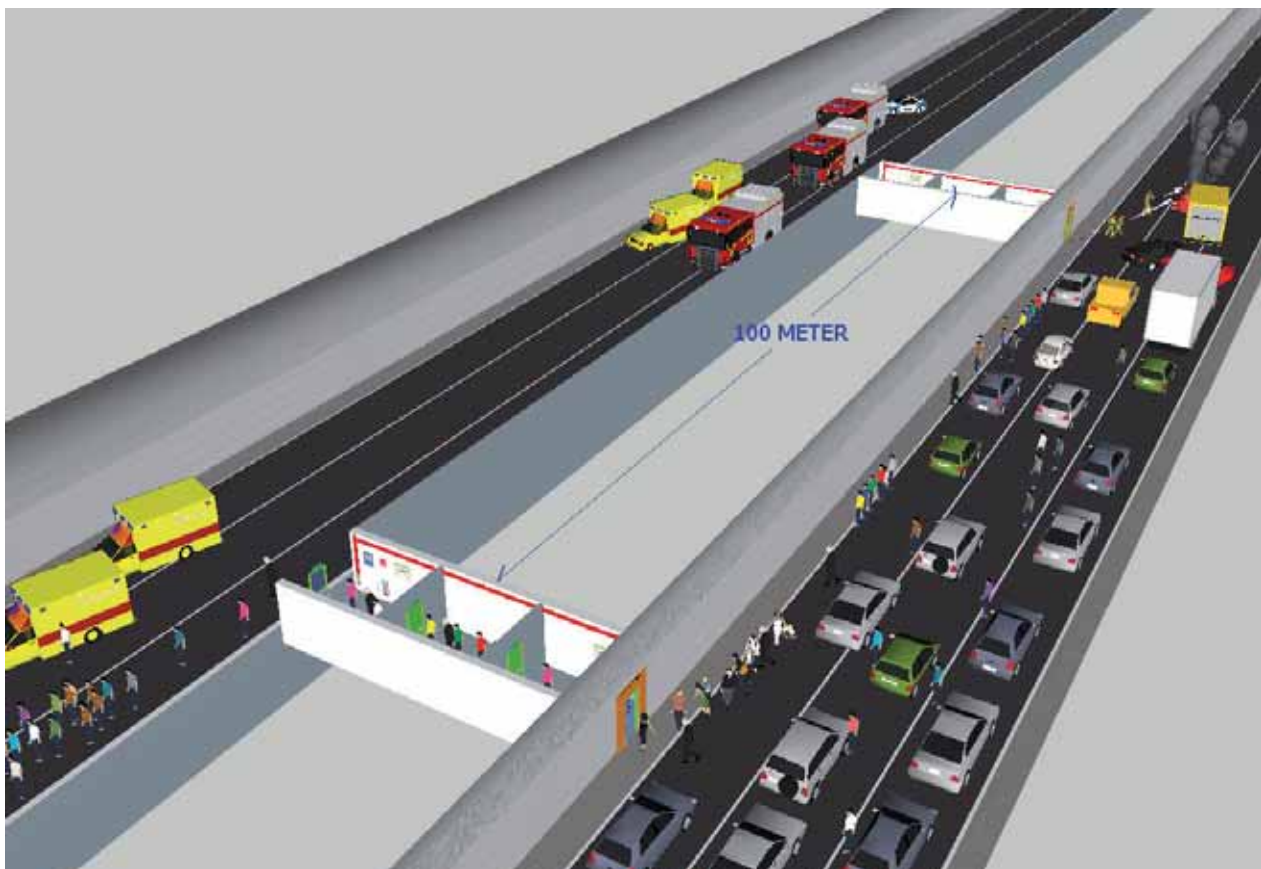
Figur 10.1 De två tunnelrören kommer att förbindas av utrymningsvägar så att man vid en olycka kan ta sig över till det andra tunnelröret. Båda tunnelrören stängs av för inkommande trafik vid en olycka.
