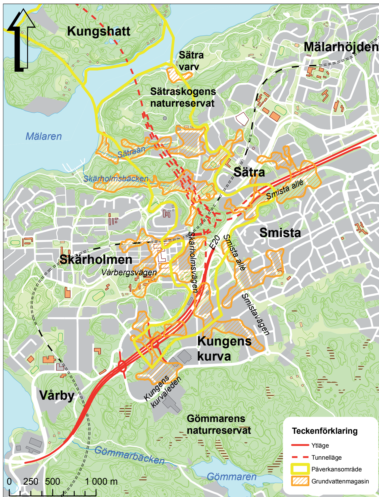
Figur 16.29 Grundvattenmagasin och påverkansområde längs delsträckan Lindvreten-Sättra.
