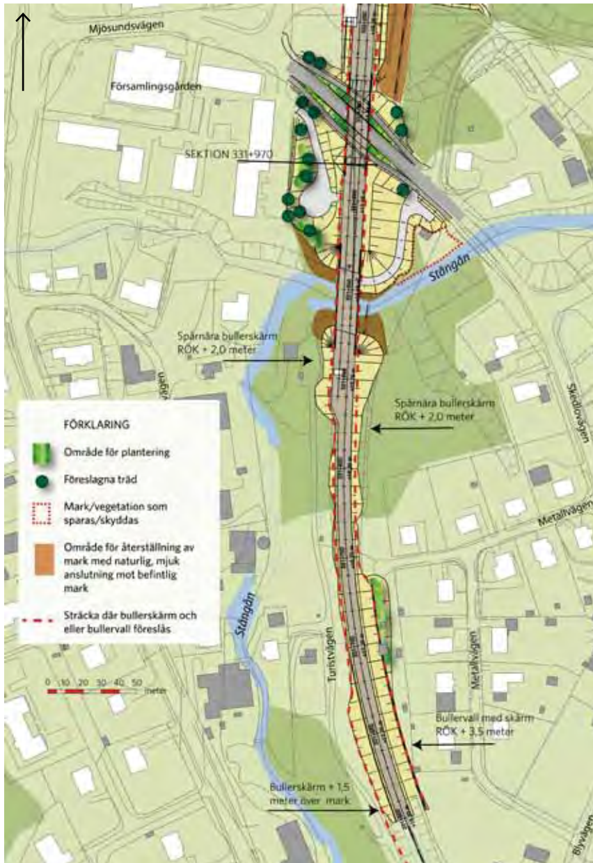
Karta 6 visar landskaps- och gestaltungsåtgärder i området från bron över Mjösundsvägen och söderut.
