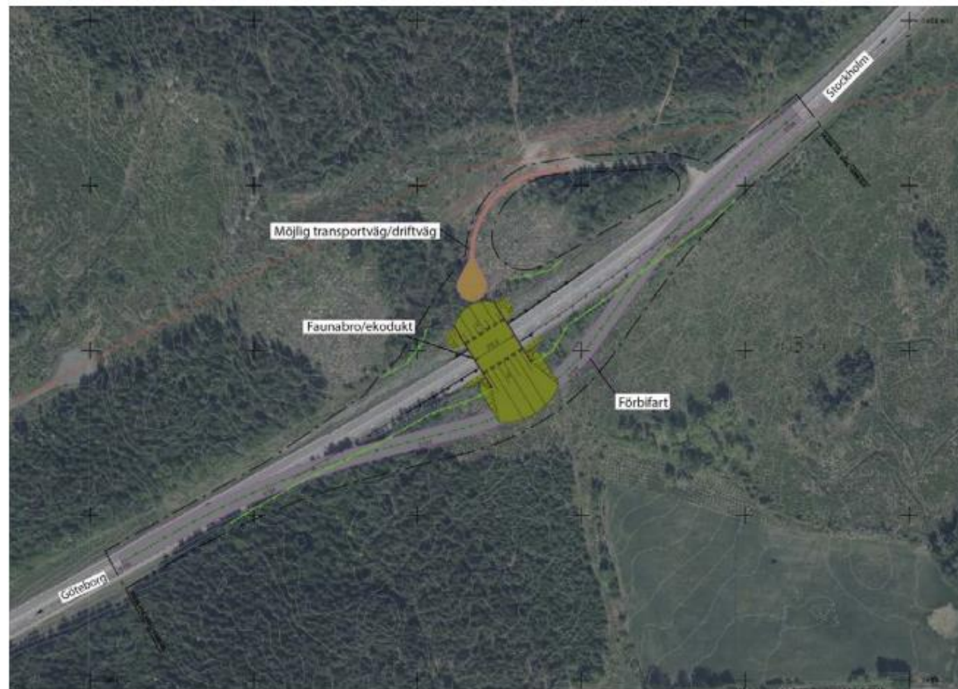
Figur 29. Tidig planskiss av faunabron i föreslaget läge. Föreslagen förbifart leder trafiken söder om arbetsområdet. Möjlig transportväg eller driftväg finns norr om faunabroläget.
