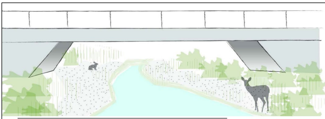
Figur 15 Skiss över järnvägsbro som ger djur möjlighet att passera utmed vattnet under bron.
