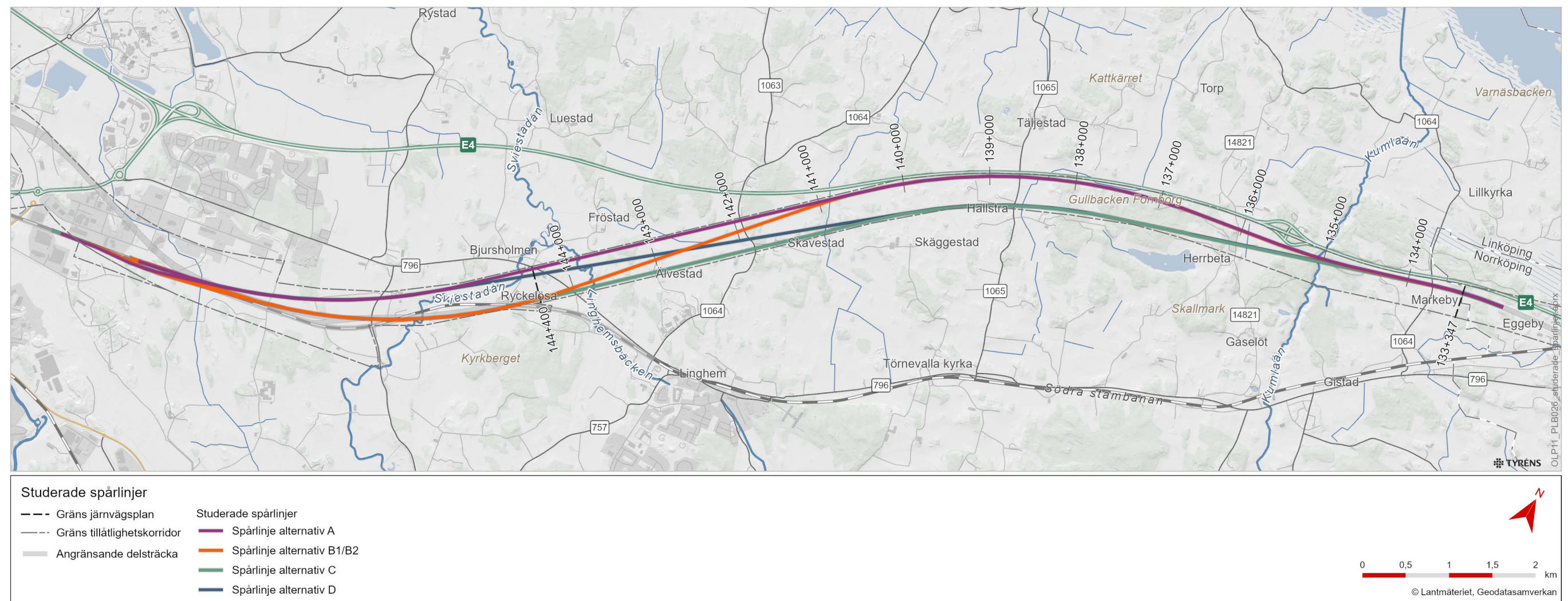
Figur 4.2 Alternativa spårlinjer som studerades i PM Förslag till spårlinje, förutom alternativ D som valdes bort i tidigt skede. Alternativ B1 och B2 vilka har samma plangeometri. Alternativ B2 valdes.
